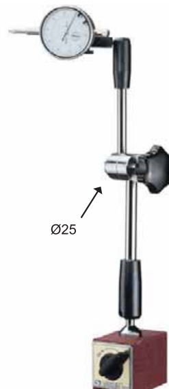
SİPARİŞ NO. VMB-106H HİDROLİK KOLLU MANYETİK AYAK /100kg
